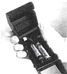
Ne pas déconnecter le câble d'alimentation pendant l'opération, ceci n'étant prévu que pour le remplacement des bloc pile ou du bloc électronique dans le cadre de la maintenance telle que décrite en Point 4
