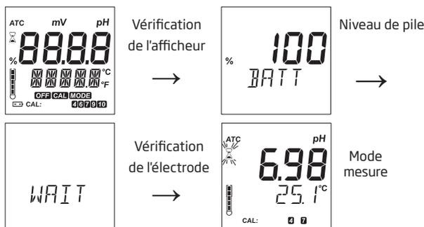
*Note : L'instrument détecte la présence et le type de sonde à son entrée.*
