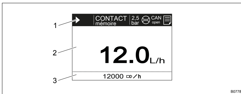
Fig. 6 : Structure de l'affichage permanent
