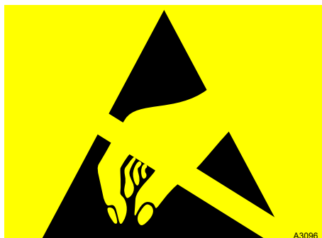
Fig. 128 : Composants avec un risque de décharge électrostatique
