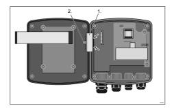
Fig. 50: Dismantling the hinge
