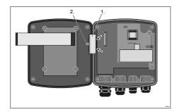
Fig. 45: Dismantling the hinge
