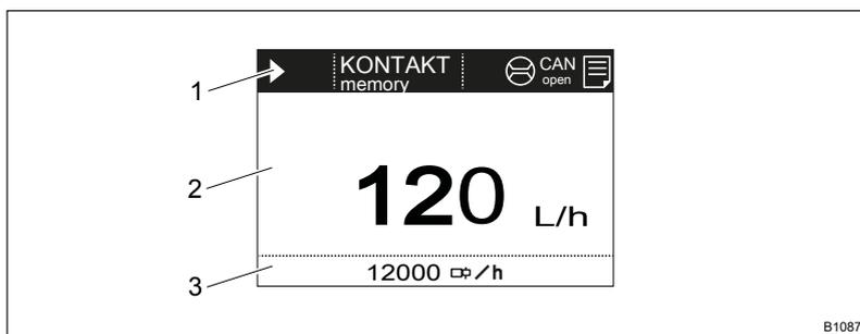
Abb. 6: Aufbau Daueranzeige
