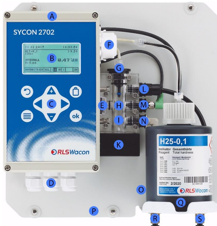
Abbildung 20: Analysegerät SYCON 2702 mit eingesetzter Indikator-Flasche
