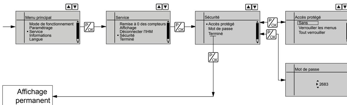
Le menu « *SÉCURITÉ* » permet d'indiquer pour quels réglages un « *accès protégé* » doit s'appliquer et de déterminer un « *mot de passe* ».
