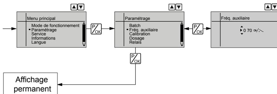
La fonction programmable « *Fréquence auxiliaire* » permet d'activer une fréquence d'impulsions supplémentaire, qui peut être prédéfinie dans le menu « *Fréq. auxiliaire* ». Elle peut être activée par le biais de la prise femelle « *Commande externe* ». Lorsque la fréquence auxiliaire est utilisée, l'affichage « *Aux* » apparaît sur l'écran LCD.
