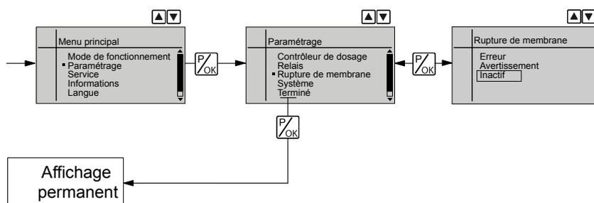
Grâce à la fonction programmable « Rupture de membrane », vous pouvez adapter le comportement de la pompe en cas de défaut à vos exigences propres, à condition de raccorder un capteur de rupture de membrane électrique.
