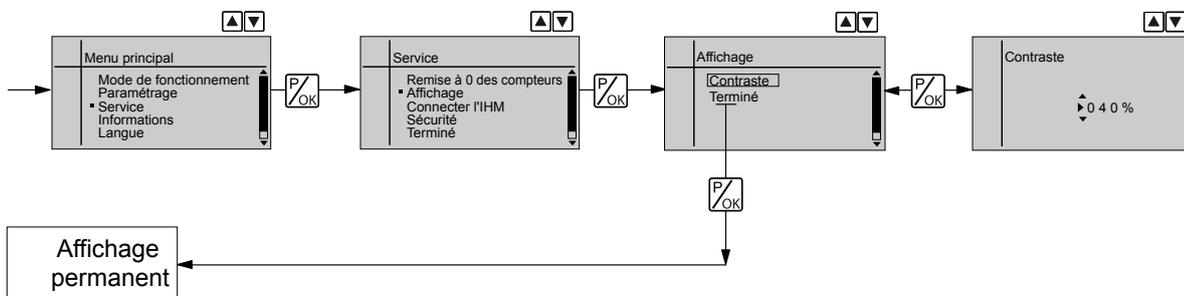
Le sous-menu « *AFFICHAGE* » permet de modifier le contraste de l'écran LCD grâce aux [touches fléchées].
