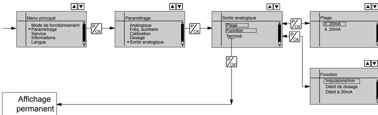
Grâce à la fonction programmable « Sortie analogique », vous pouvez adapter le signal de la sortie analogique de la pompe (option) à vos exigences propres.
