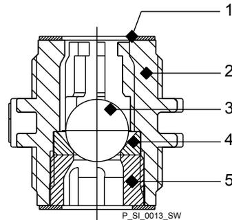
Fig. 32: Clapet à bille unique, vue en coupe
