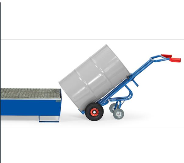
Fasskarre aus Stahlrohr geschweißt, pulverbeschichtet, blau RAL 5007, dauerhaft oberflächengeschützt. Räder mit Luftbereifung, Naben mit Rollenlager. Für alle 200-Liter-Fässer mit Rand geeignet. Zusätzlich mit 2 Stützrädern Vollgummi 160 x 40 mm.
