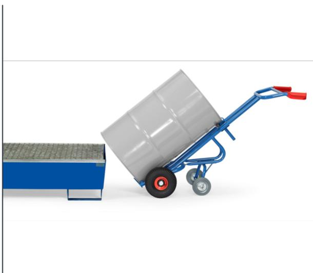
Ensemble mécano-soudé, revêtement époxy bleu RAL 5007. Diabie compatible pour fûts acier de 200 litres avec rebord. Roues gonflables, moyeu à roulement à rouleaux. 2 roues d'appui à bandage caoutchouc bleu gris Ø 160 x 40 mm. Permet de positionner les fûts remplis de façon sûre sur des palettes ou bacs de rétention d'une hauteur jusqu'à 360 mm. Longueur : 1600 mm ; Largeur : 680 mm.
