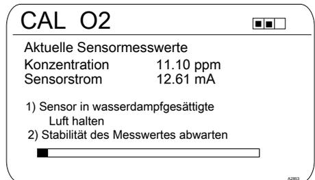
Abb. 72: Sensor in wasserdampfgesättigte Luft halten
