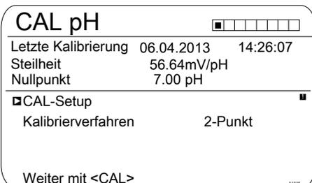
Abb. 43: Kalibrierung pH-Sensor (CAL)
