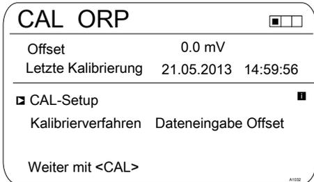
Abb. 56: Dateneingabe-Kalibrierung Redox-Sensor (CAL)
