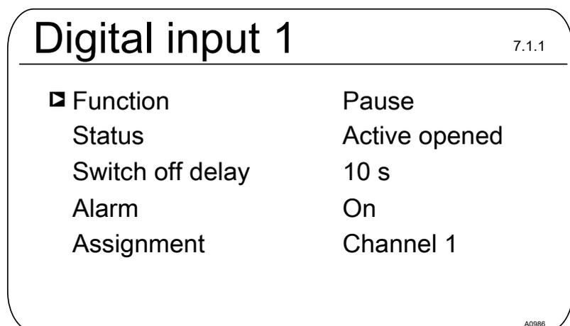
Fig. 84: Setting [Digital input 1]
