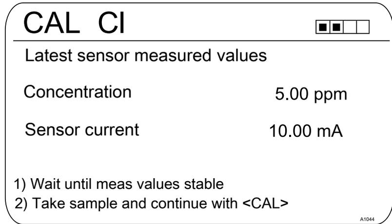
Fig. 40: Reference value calibration shows the actual sensor values
