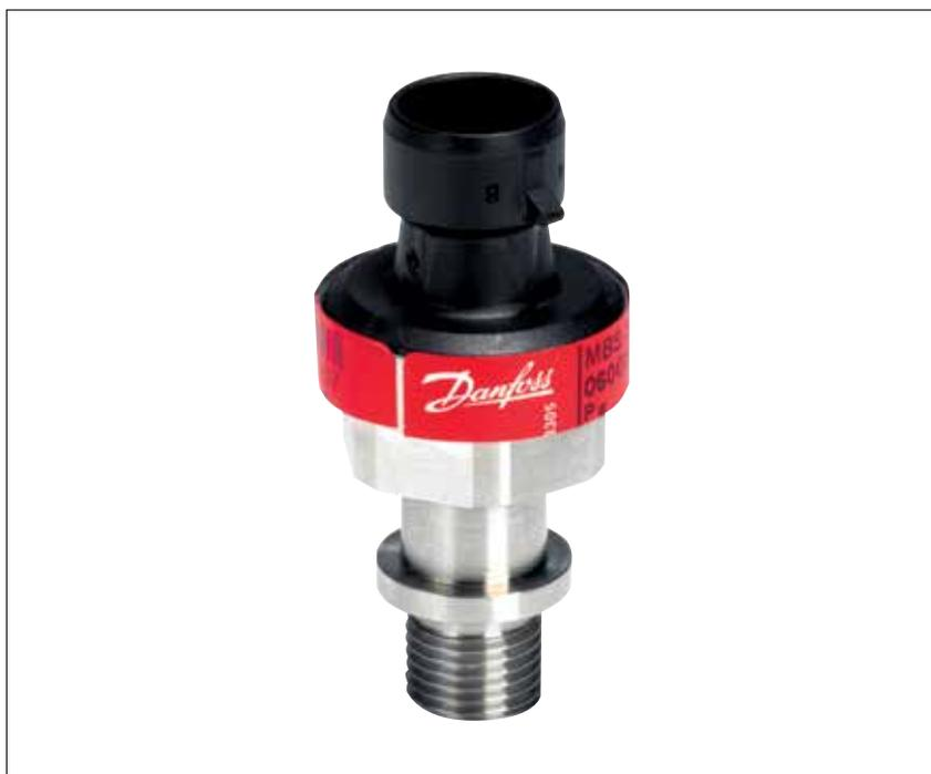
Der Druckmessumformer MBS 1900 wurde für Luft- und Wasseranwendungen, wie Druckerhöhungspumpen und Luftverdichter, entwickelt. Das halb-flexible Druckmessumformer-Programm deckt verschiedene Ausgangssignale, Ausführungen für Absolut- oder Relativdruckmessung, Messbereiche von 0 – 4 bis 0 – 25 bar und eine breite Palette von Druck- und elektrischen Anschlüssen ab. Das Gehäuse ist aus AISI 316L Edelstahl hergestellt.
