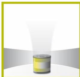
La substance active monte, laissant à l'opérateur le temps de sortir de la pièce. Il est propulsé par un temps de combustion lent et non pyrotechnique.
